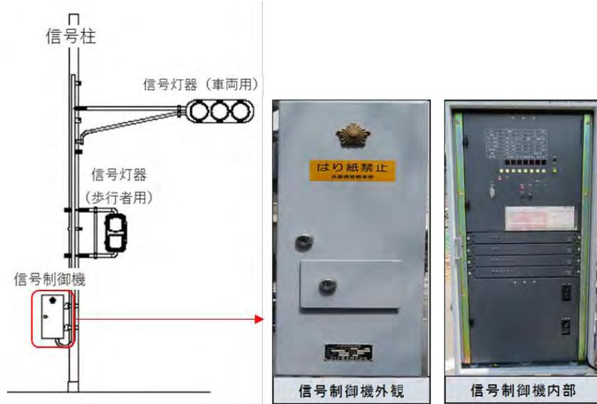
\* 信号機は、信号灯器とそれを支える信号柱、および信号を制御する信号制御機から構成される。信号機器のうち、信号制御機の単価は最も高くまた更新すべき基準年数も19年と短い。
